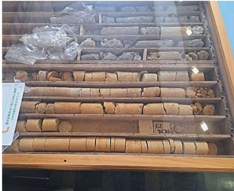
角島大橋の基礎地盤の ボーリングコア
