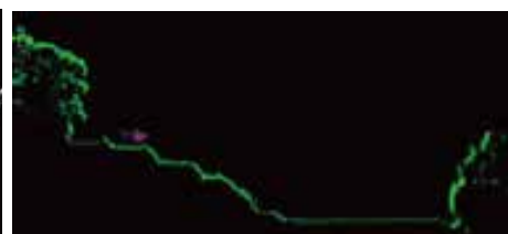
UAV レーザ点群データ
